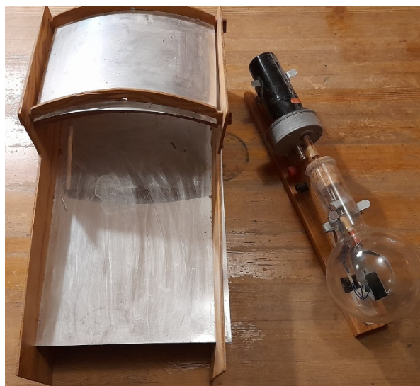
Två av artefakterna som jag ställde ut på NGO Forum i Nairobi 1981: Tvåparabol-koncentrator och instrålningsmätare.
