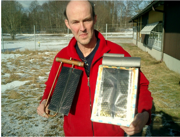
S(k)olfångaren. Artefakt för laborationer i solvärme på alla nivåer från förskola till högskola. Kjell Gustafsson visar både s(k)olfångaren och en elevbyggd solfångare.
